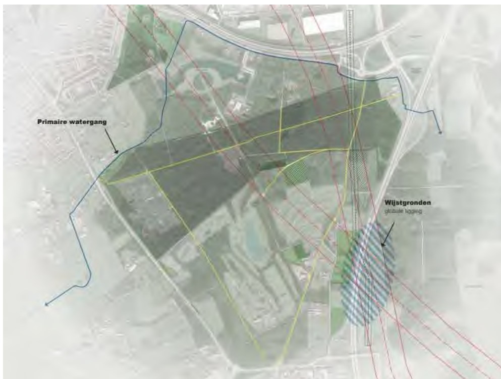
Figuur 2.2: Ruimtelijke kaders als gevolg van het bodem- en watersysteem. De watergangen (blauwe lijn) en de wijstgronden (blauw gearceerd). De wijstgronden zijn natte, hoge gebieden veroorzaakt door de breuklijn.
